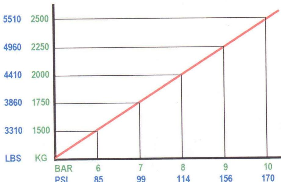
La portata del sollevatore è proporzionale alla pressione di alimentazione e ricavabile dal diagramma sopra riportato.
