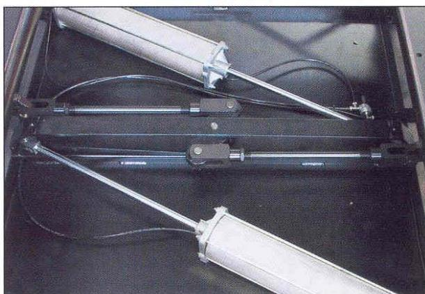
**La capacità di sollevamento** (2500 Kg) è prodotta da due cilindri pneumatici a doppio effetto con comando a pedale.
