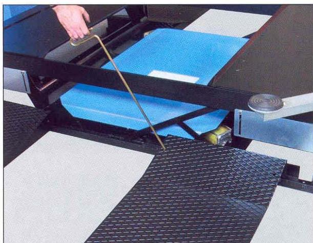
**Le rampe di salita mobili** permettono le operazioni di equilibratura di finitura. La configurazione a doppio stadio consente a tutte le vetture, anche a quelle sportive e con spoiler anteriore, di salire senza toccare sulla piattaforma.
