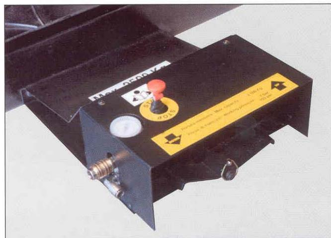
La pedaliera è dotata di pulsante a fungo per eventuali arresti di emergenza e di una presa d'aria supplementare alla quale possono essere collegati eventuali attrezzi: avvitatore, pistola di gonfiaggio, etc.
